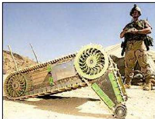
阿富汗参加反恐作战的“赫耳墨斯” 价值4万美元，可携带2架摄像机， 发挥了很好作用。
