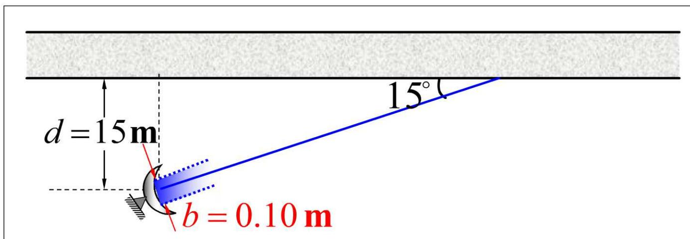
**解** 将雷达天线输出口看成是发出衍射波的单缝，衍射波能量主要集中在中央明纹范围内。
