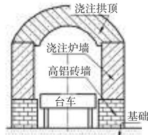
图5 改造后加热炉炉墙
