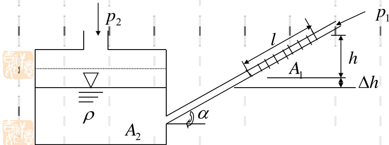
图 倾斜式微压计
