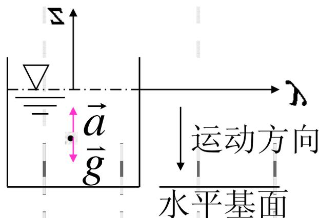
图 2—13 容器匀加速直线运动的两种特例
