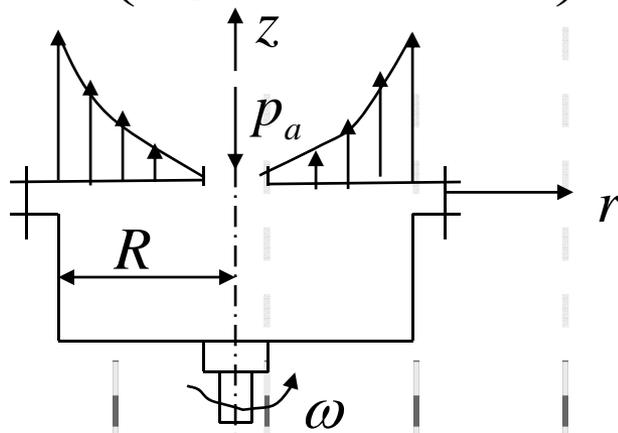
图b顶盖中心开口容器
