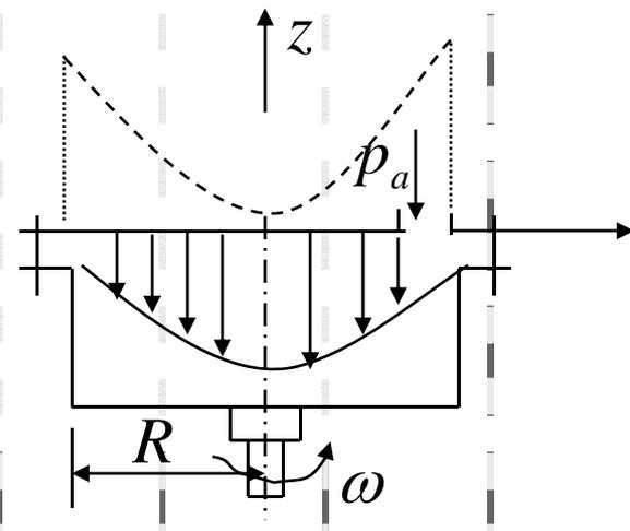
图c顶盖边缘开口容器
