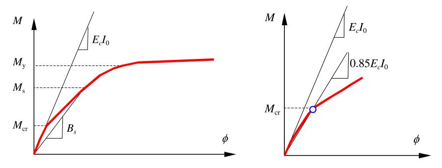
正常使用条件下通常处于第 II 阶段,刚度计算需要研究构件带 裂缝时的工作情况。
