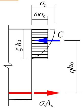
9.1 钢筋混凝土受弯构件的挠度验算
