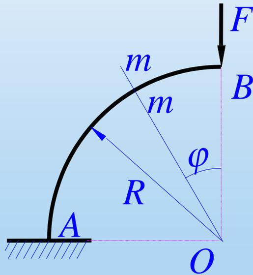
例5-14 一端固定的四分之一圆环，半径为 $R$ ，在自由端 $B$ 受轴线平面内的集中荷载 $F$ 作用如图，试作出其内力图。
