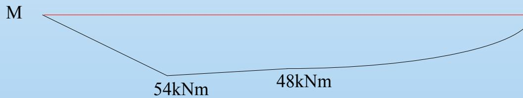
P<sub>145</sub> 4-7 试根据图示简支梁的弯矩图作出两的剪力
