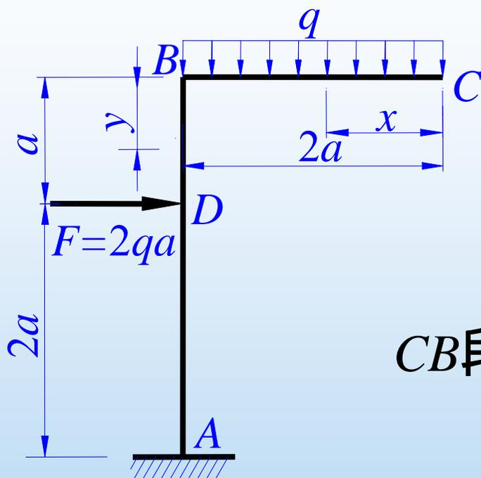
解：从自由端取分离体作为研究对象写各段的内力方程，可不求固定端A处的支反力。
