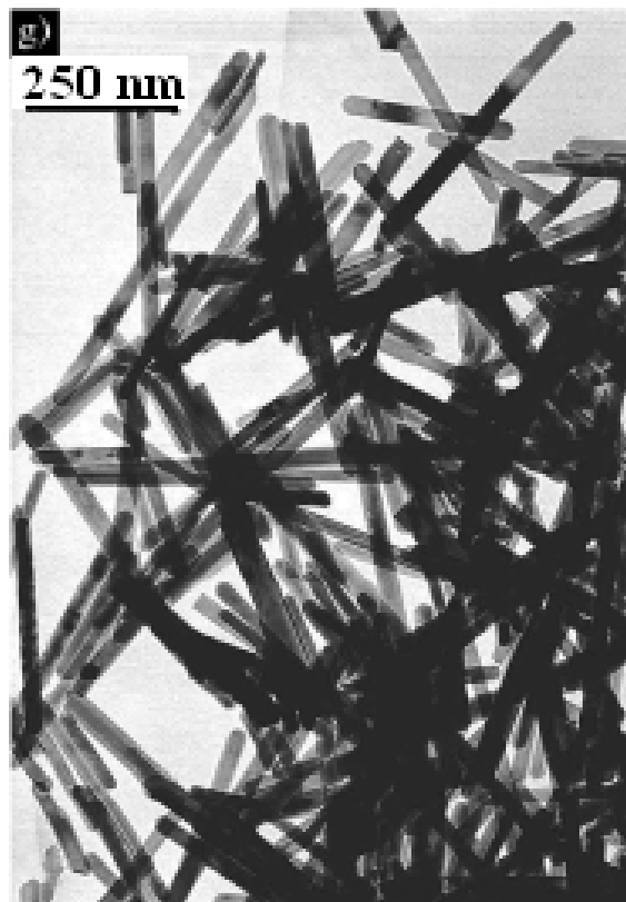
图3-6 稀土氢氧化物纳米线的(HR)TEM照片: g) \text{Eu}(\text{OH})_3 , h) \text{Ho}(\text{OH})_3
