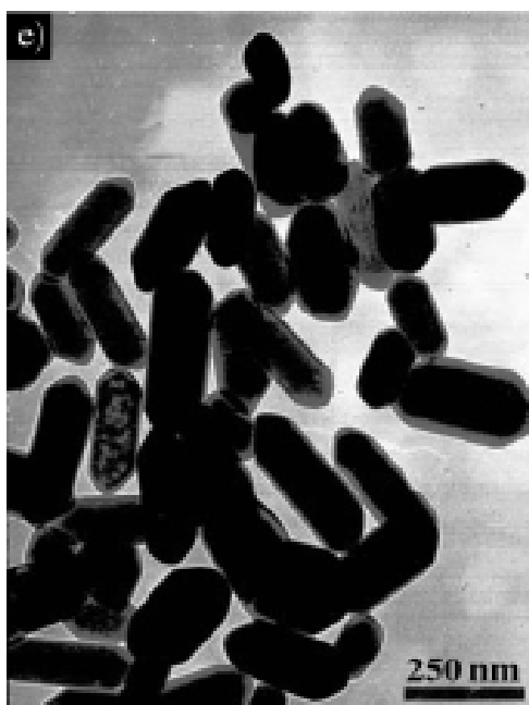
图3-7 不同碱度下所得稀土氢氧化物纳米晶的TEM照片：(a) \text{Sc}(\text{OH})_3 纳米片 (pH = 6-7)，(b) \text{Sc}(\text{OH})_3 纳米线 (pH = 9-10)，(c) \text{Sc}(\text{OH})_3 纳米棒 (KOH, 5mol/L)；(d) \text{Gd}(\text{OH})_3 纳米线 (pH = 7)，(e) \text{Gd}(\text{OH})_3 纳米棒 (KOH, 5mol/L)
