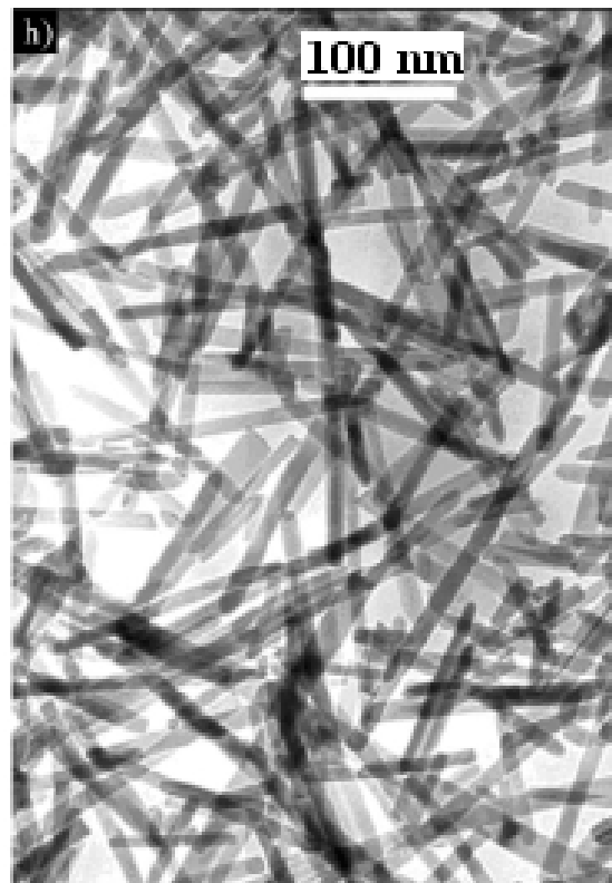
图3-6 稀土氢氧化物纳米线的(HR)TEM照片: g) \text{Eu}(\text{OH})_3 , h) \text{Ho}(\text{OH})_3
