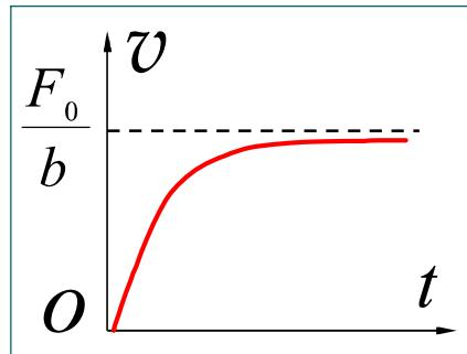
若球体在水面上是具有竖直向下的速率  $v_0$ ，且在水中的重力与浮力相等，即  $F_B = P$ 。则球体在水中仅受阻力  $F_r = -bv$  的作用
