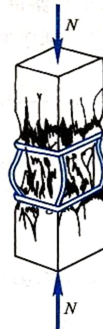
轴心受压短柱的破坏形态
