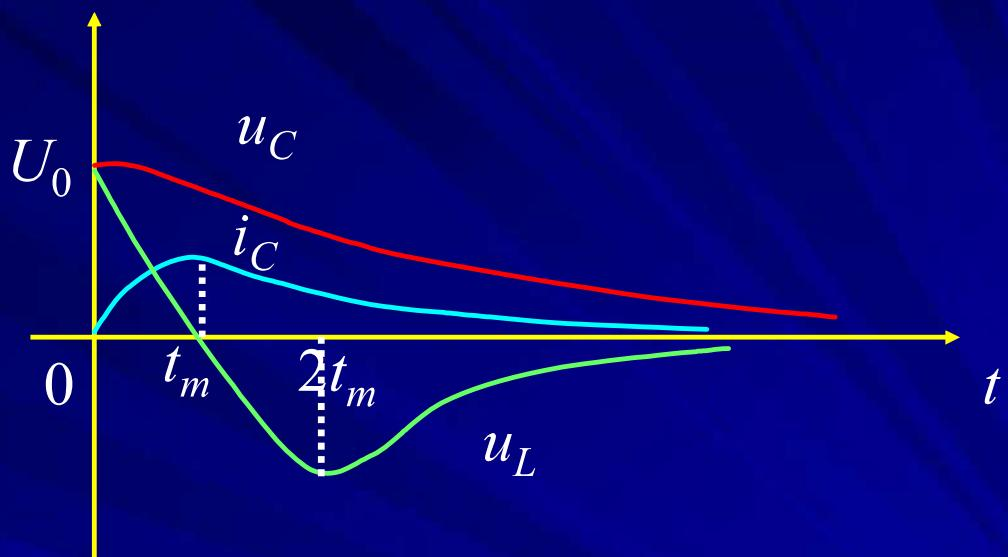
$0 < t < t_m \quad u_C$  减小 ,  $i$  增加。  $t > t_m \quad u_C$  减小 ,  $i$  减小。
