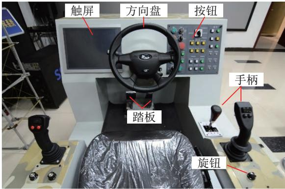
图 9 模拟驾驶舱及操纵控制系统硬件
