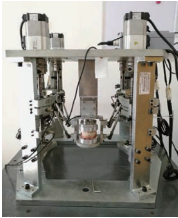
图3 义齿性能测试咀嚼机器人样机
