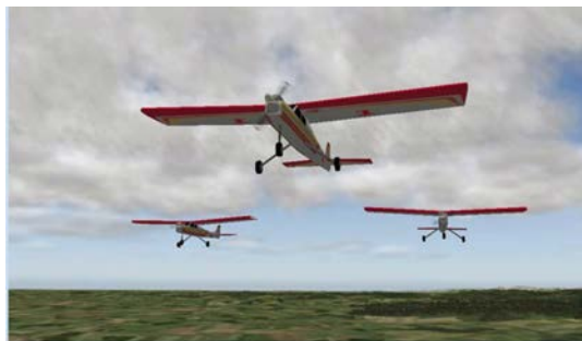
图 14 HIL 仿真过程中 3 架无人机编队飞行的 X-Plane 界面 Fig.14 A view of 3-UAV formation flight within X-Plane simulator in HIL simulation
