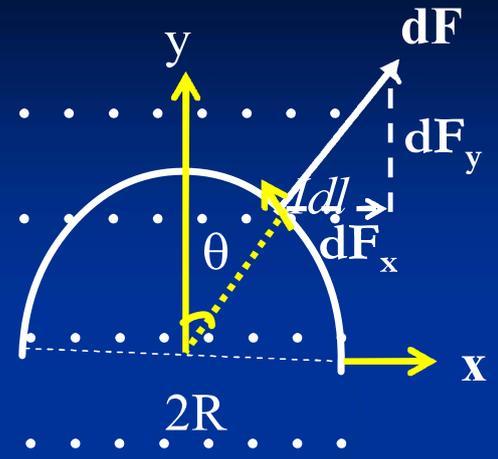
**例8.11** 半径为**R**的半圆形载流导线，电流强度为**I**，放在磁感应强度为**B**的均匀磁场中，求它所受的磁力
