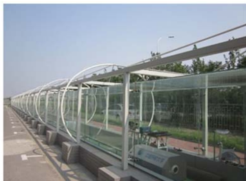
图 4 大气模拟舱实物图
