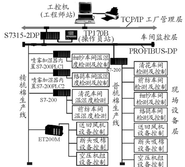
图 1 基于 Profibus-DP 总线的温湿度控制系统网络结构
