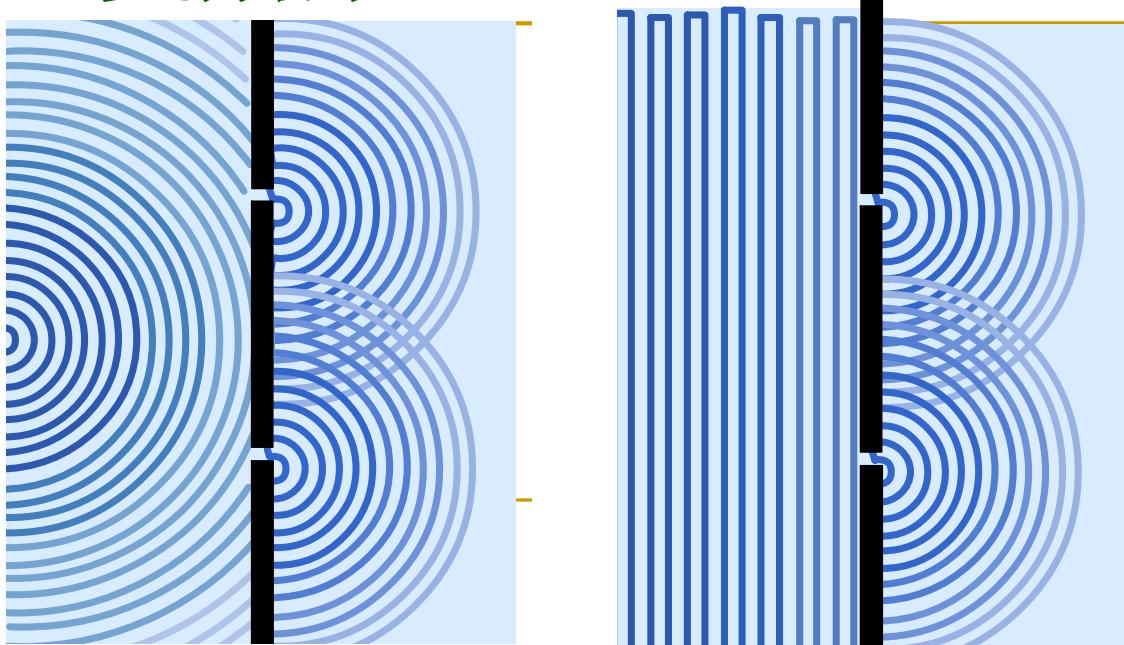
一入射波传播到带有小孔的屏时，不论入射波的波阵面是什么形状，通过小孔时，在小孔的另一侧都产生以小孔作为点波源的前进波，可将其抽象为从小孔处发出的一种次波或子波，其频率与入射波频率相同。
