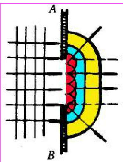
靠近狭缝的边缘处，波面弯曲，波线改变了原来的方向，即绕过了障碍物继续前进。
