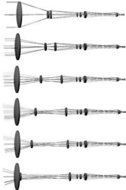
图 3 连续变焦光学系统图
