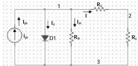
图 1 太阳能电池板的等效电路图
