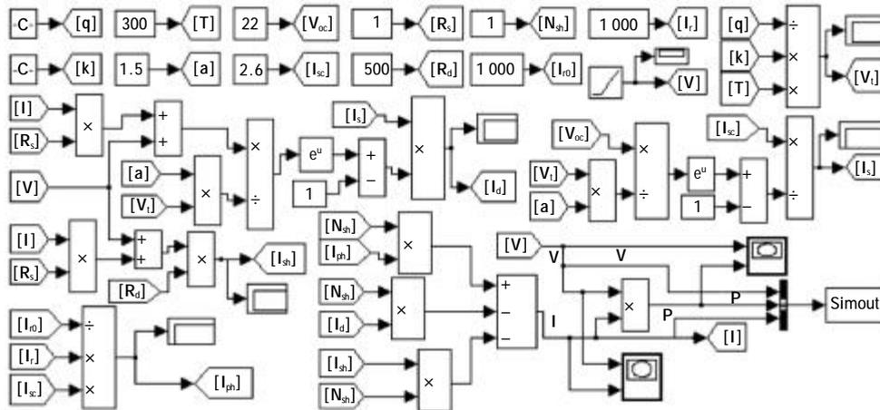
图 2 建立于 Simulink 中的太阳能电池板模块
