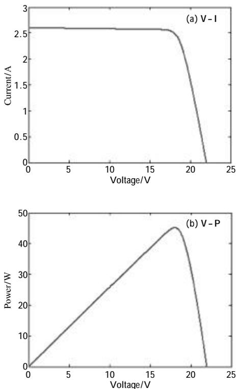
图 3 电池板的电压-电流、电压-功率关系曲线
