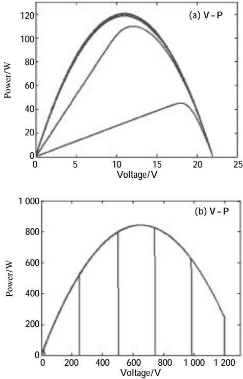
图 4 不同并联、串联电池板个数的电压-功率曲线
