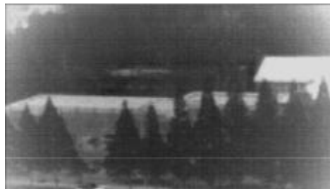
图 1 含有实际条纹非均匀性的非制冷凝视型图像
