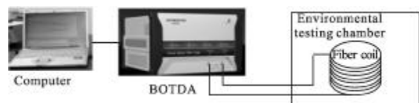
图 1 基于 BOTDA 的光纤环应力分布测试平台
