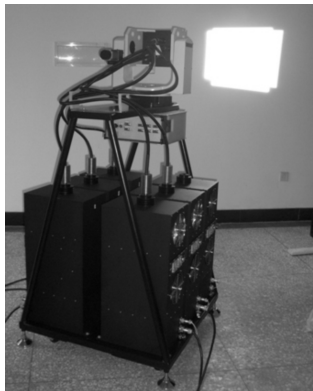
图 8 便携式太阳模拟器加电效果图(5 台设备同时加电的效果)
