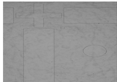
(d) 新刻蚀工艺刻蚀 12 min (d) New process with 12 min
