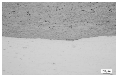
图 3 试样 2#的铝/钛界面金相照片(500×)
