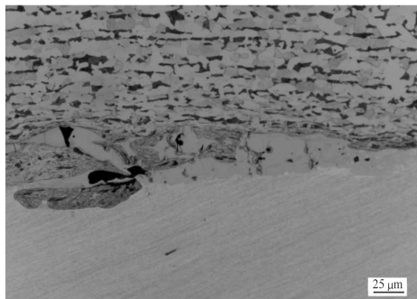
图 2 试样 1#的铝/钢界面金相照片(500×)
