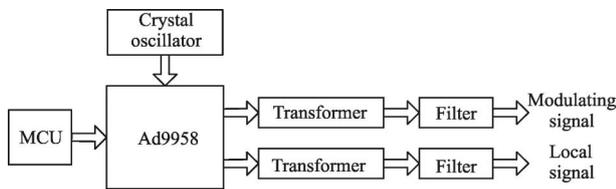
图 2 线性调频信号产生电路的结构框图
