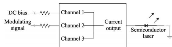
图 5 半导体激光器驱动电路原理图
