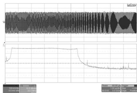
图 6 线性调频信号产生电路输出波形
