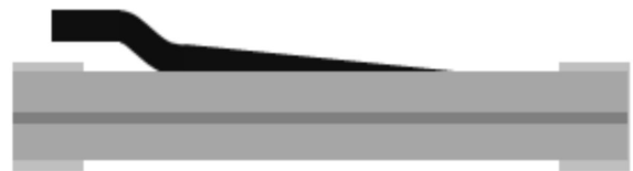
图 1 高功率非对称泵浦耦合器
