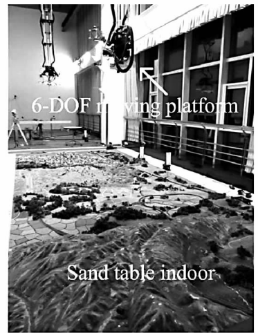
图 5 室内地形沙盘和 6 自由度相机移动平台 Fig. 5 Indoor terrain sand table and 6-DOF camera moving platform
