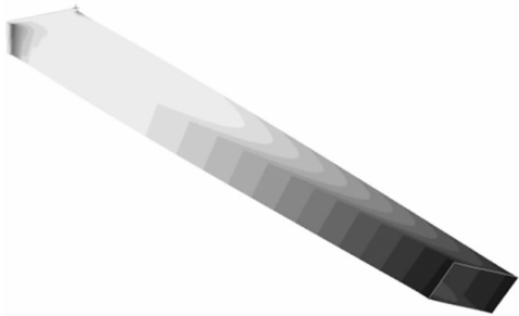
图10 盒型悬臂梁拉力作用下的变形示意图
