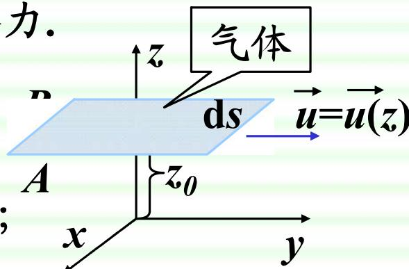
$$\text{输运的定向动量: } dK = -\eta \left( \frac{du}{dz} \right)_{z_0} ds dt$$
