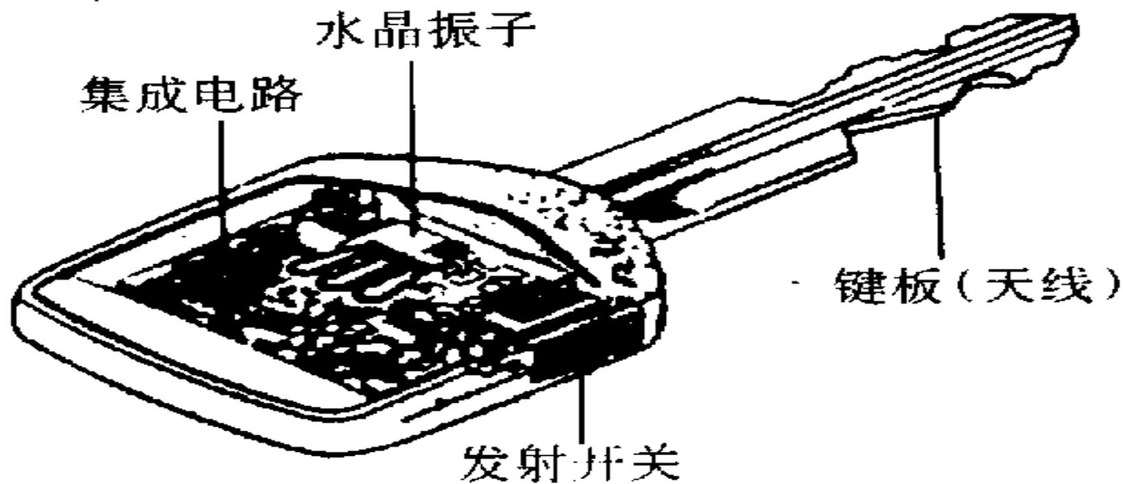
图 22-15 遥控门锁发射器
