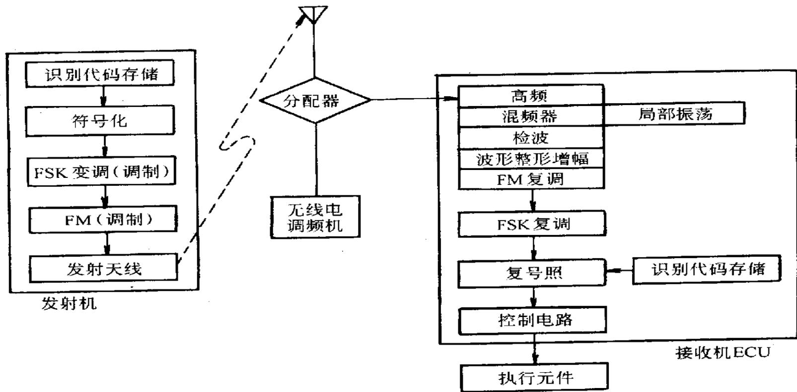
图 22-16 发射器与接收信号处理电路
