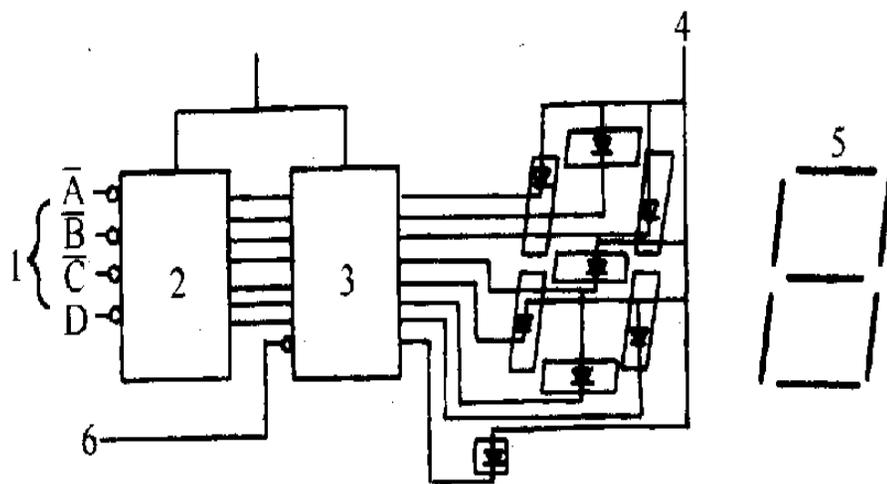
图 22-2 七划数字发光二极管显示装置
