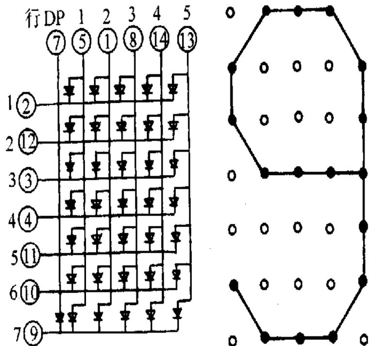
图 22-3 光点阵式发光二极管显示装置
