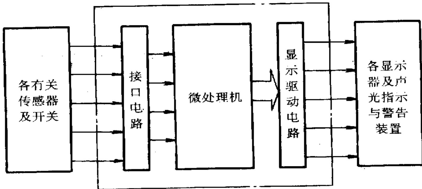
图 22-1 电子仪表系统框图
