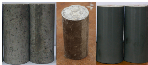
喷涂前 打磨、填充、刷漆 喷涂后
