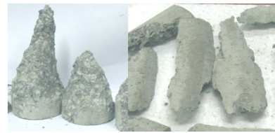
(a) 无聚脲包覆混凝土残留物
