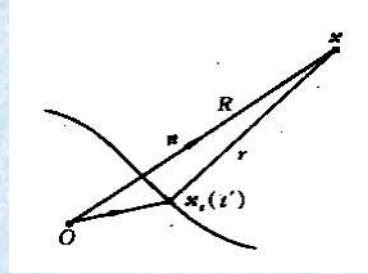
$$\vec{A}_\omega(\vec{x}) = \frac{\mu_0}{8\pi^2 \epsilon_0 c^2} \frac{e^{ikR}}{R} \int_{-\infty}^{\infty} \vec{v}(t') e^{i\omega\left(t' - \frac{\vec{e}_r \cdot \vec{x}_e}{c}\right)} dt'$$
