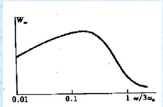
圆周运动是周期性的，辐射可展为博里叶级数，频谱是基频 $\omega_0$ 的整数倍，包括从 $\omega_0$ 到 $\omega_c$ 的各分量。精确计算出的辐射频谱如图 所示
