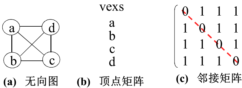
图7-5 无向无权图的数组存储
