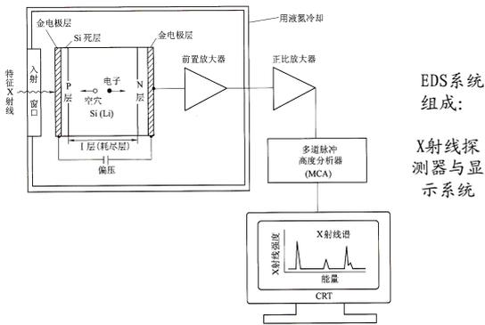
为了使硅中的锂稳定和降低FET的热噪声，平时和测量时都必须用液氮冷却EDS探测器。
