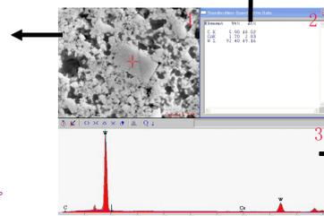
EDS谱线实时收集的结果，纵坐标是X射线光子的计数率CPS，横坐标是元素的能量值 (KeV)。
