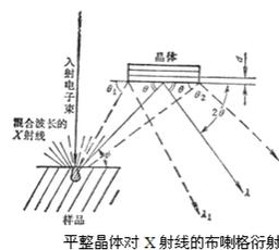
平面晶体对X射线的布拉格衍射
