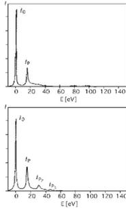
**等离子损失峰**：入射电子与导体或半导体样品中的自由电子气交互作用，使电子气振荡，能量**0-50eV**范围。
