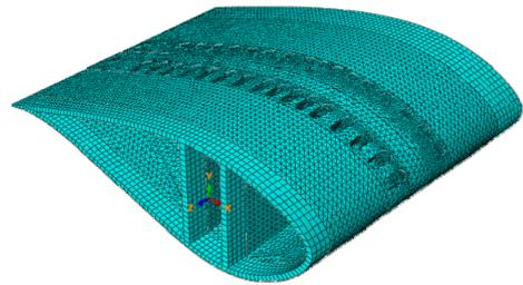
图 13 叶片连接段的网格划分
