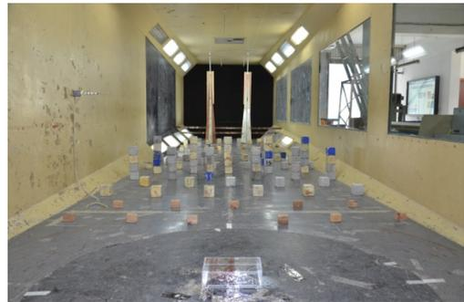
图2 边界层风洞中的TTU模型
