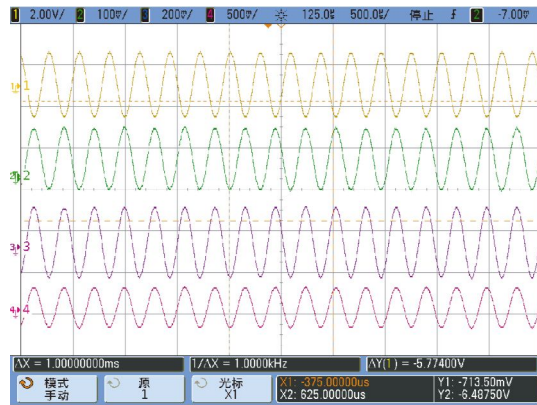
图 10 正交校正前陀螺检测通道中信号
