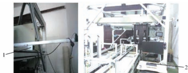
图 13 移栽动平台定位精度测量
