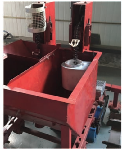
图9 漏种自动补种性能试验样机
