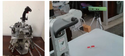
图5 手控器-机器人遥操作系统实验平台
