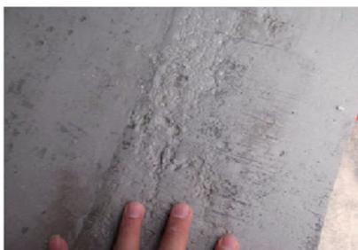
图3 筒体内表面底部腐蚀情况(部分)
