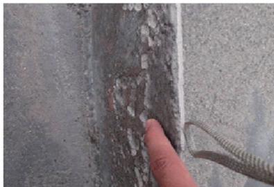
图2 浮头隔板腐蚀情况
