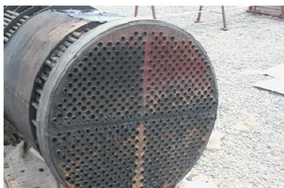
图4 管板与换热管结合部位腐蚀情况
