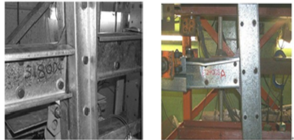
图3 钢板-螺栓连接节点 [52]
