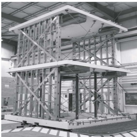
图 2 足尺模型振动台试验 [33]
