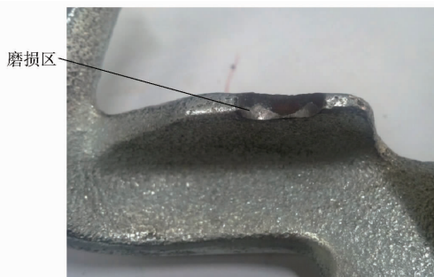
图 2 脱扣凹槽的磨损
