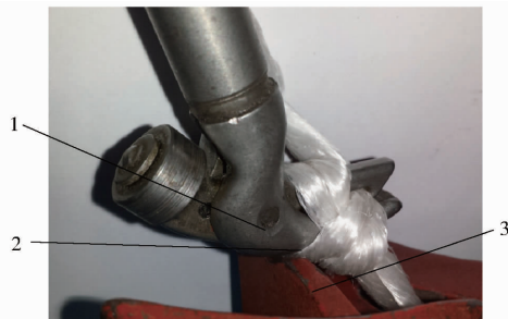
图 1 脱扣凹槽与打结嘴夹住绳环
