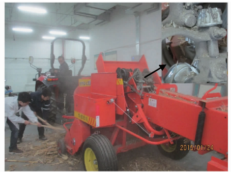
图 15 弹性化打结嘴轴系打捆试验
