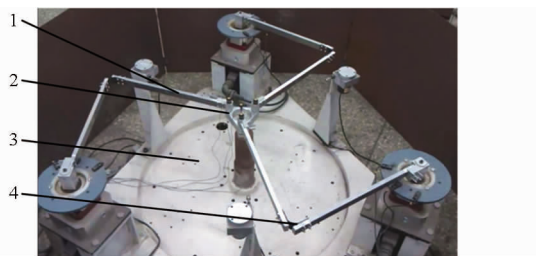
图12 含有柔顺关节的平面并联机器人机构
