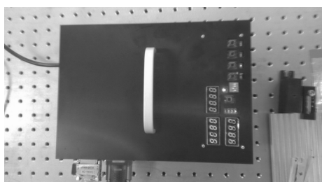
图 12 遥控遥测系统控制激光器电源和激光器以 2 Hz 频率出光图(计数 30 次)
