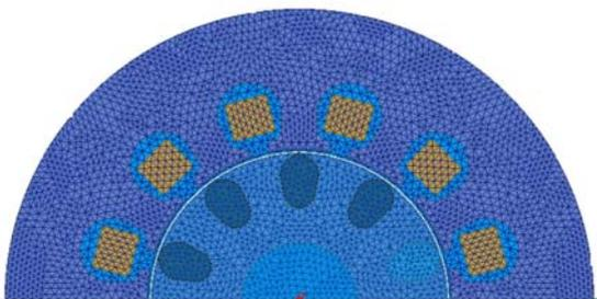
图 8 划分网格的有限元模型
