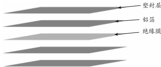
图 2 断通靶结构示意图
