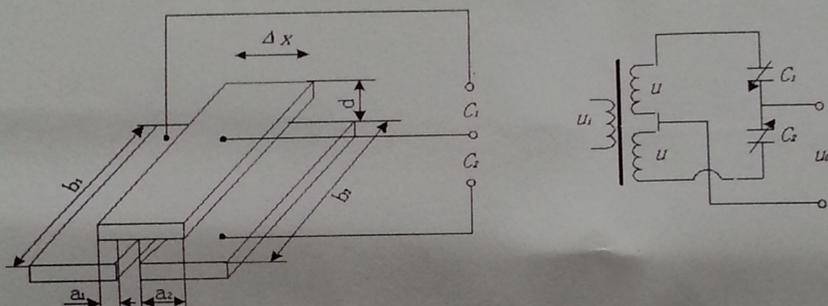
3、有一只差动电感位移传感器，已知电源电压  $U_{sr}=4V$ ， $f=400Hz$ ，传感器两线圈  $L_1$  和  $L_2$  的铜电阻与电感量分别为  $R=40\Omega$ ， $L=30mH$ ，用两只匹配电阻设计成四臂等阻抗电桥，如图所示，试求：（10 分）
