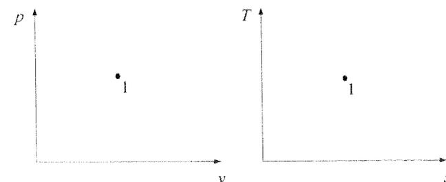
2、某理想气体工质进行稳定绝热流动, 由初态  $p_1$ 、 $T_1$  膨胀到终态  $p_2$ , 若过程一为可逆, 另一为不可逆, 设  $c_p$  为定值。(1) 将两过程在 p-v 和 T-s 图上表示出来;(2) 分析比较两过程所做技术功的大小, 并将其差值在 p-v 图上表示出来。
