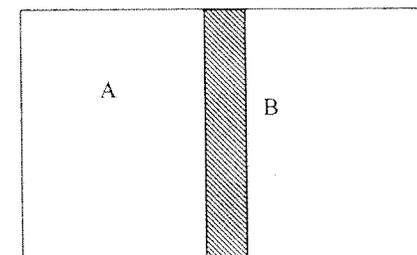
2、冬季利用热泵从大气中抽取热量用以维持  $15^{\circ}\text{C}$  的室温, 当室内温度与大气温度相差  $1^{\circ}\text{C}$  时, 通过墙壁与外界交换的热流量为  $0.65\text{kW/K}$ 。求(1)如果大气温度为  $-15^{\circ}\text{C}$ , 驱动热泵所需的最小功率是多少? (2) 夏季, 将同一台热泵用于空调, 热泵输入功率和温差为  $1^{\circ}\text{C}$  时墙壁与大气交换的热流量同上, 若维持室温为  $15^{\circ}\text{C}$ , 问最大允许的大气温度是多少?
