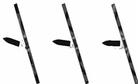
图9 速度为700 m/s时弹体侵彻过程
